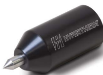
Opleidingstools voor toortsen De toortsopleidingstools stellen systeemoperators in staat de snijroute van de robot te programmeren en ondertussen visueel te controleren of de toorts het werkstuk niet zal raken bij het snijden.
